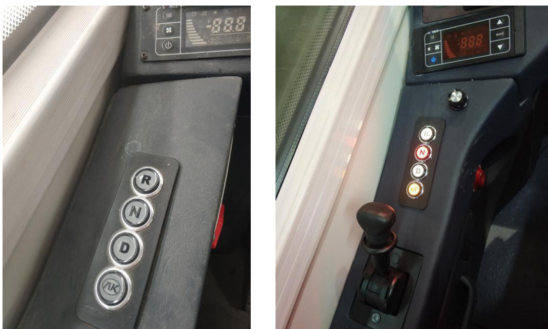
图 24 N 档位置、手制动阀位置
